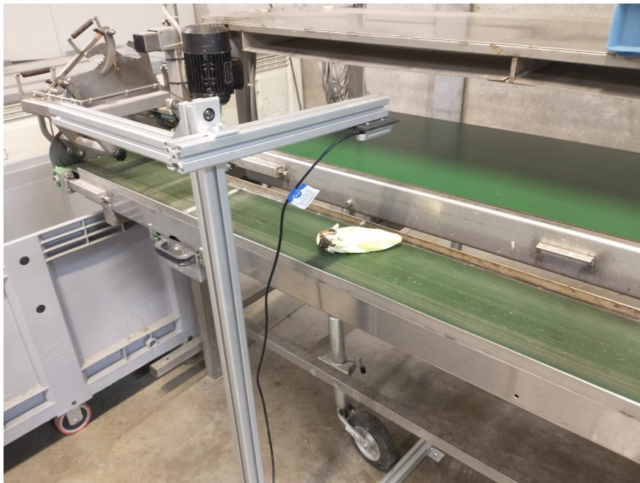
Figuur 3.3: Opstelling voor het nemen van foto's van witloofkroppen met deels gesneden wortels.
