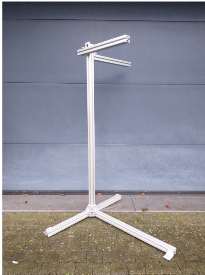
Figuur 3.1: De gebruikte camera constructie voor het nemen van de beelden.
