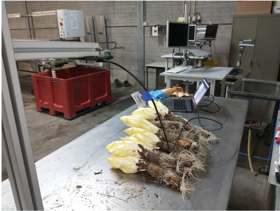
Figuur 3.2: Opstelling voor het nemen van foto's van witloofkroppen met de wortel
