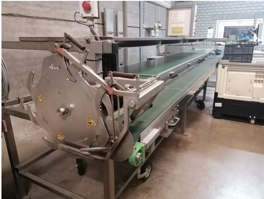
Figuur 1.1: De snijmachine waarmee het witloof van de wortels gesneden wordt.
